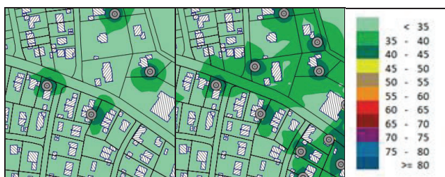
Abbildung 3: Ausschnitte aus den Lärmkarten für das Modellgebiet WA mit den A-bewerteten Beurteilungspegeln im Nachtzeitraum (v.l.n.r. Bestand, Prognose)
