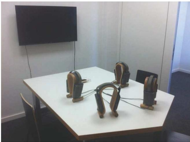
**Abbildung 2:** Hörkabine der Möhler + Partner Ingenieure AG; Darbietung der Geräusche über elektrostatische Kopfhörer der Firma Stax
